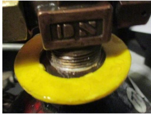
氧氣鋼瓶水壓測試環 5 年有效
