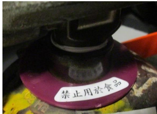
乙炔鋼瓶水壓測試環 5 年有效
